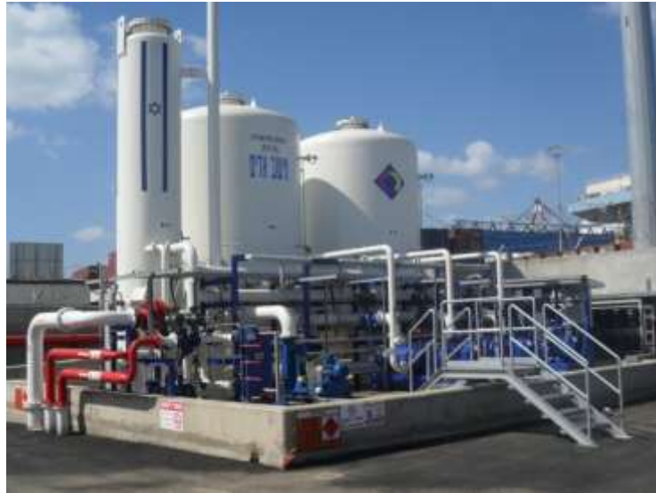
בתמונה : מער מישוב אדים בעת מילוי אוניות בתש"ן נמל הדלק
