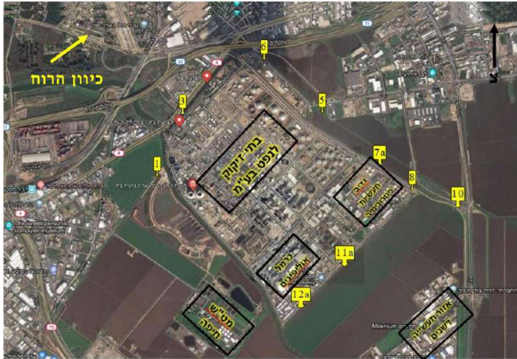
תמונה 9: תצ"א של נקודות הדיגום בהם בוצע דיגום סביבתי ופריסה של מערכת הניטור הרציף (UV DOAS) סביב מתחם בז"ן בשנת 2024
